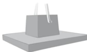
Figur: Punktfundament type 1
