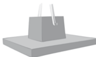
Figur: Punktfundament type 1
